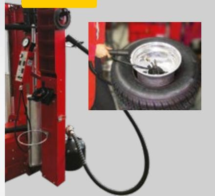
Nuovo e potente sistema di gonfiaggio tubeless (per versioni "FI") adatto a qualsiasi diametro di cerchio. Provveduto di un dispositivo di sicurezza per tutelare l'incolumità dell'operatore.
