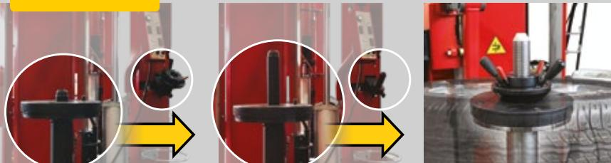
Il sistema Smart Lock permette di bloccare e sbloccare il cerchione in modo più rapido e preciso, mantenendo le caratteristiche di sicurezza e adattabilità del bloccaggio manuale
