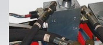
La sincronizzazione idraulica dei movimenti delle pedane è indipendente dalla ripartizione del carico; ed è garantita da un dispositivo di sincronizzazione idraulica brevettato.
