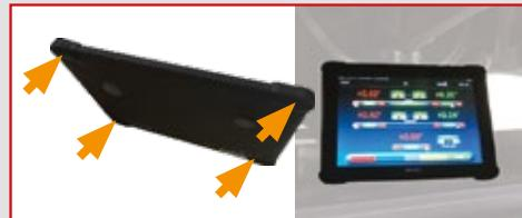
Kit magneti adesivi per la parte posteriore del tablet e supporto sospeso per fissaggio al ponte o al veicolo.
