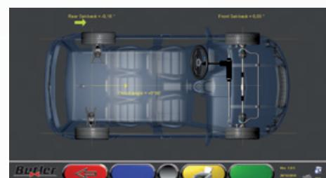
La **diagnosi rapida** del disassamento del telaio permette di evidenziare eventuali problemi di carrozzeria o di spostamento del retroreno.
