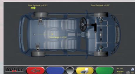
La **diagnosi rapida** del disassamento del telaio permette di evidenziare eventuali problemi di carrozzeria o di spostamento del retrotreno.
