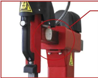
Регулируемый ролик облегчает перемещение монтажного рычага.
