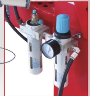
Фильтр с регулятором давления и смазывающим устройством уже в стандартной комплектации
