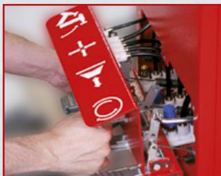
Съёмный педальный блок обеспечивает быстрый и удобный доступ к узлам и агрегатам. Может быть полностью демонтирован для проведения технического обслуживания и ремонта.
