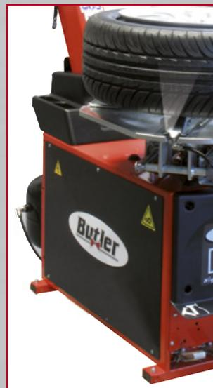
Встроенная система взрывной подкачки бескамерных шин (версия “FI”) подаёт воздух в зазор между диском и покрышкой через форсунки в зажимных кулачках, обеспечивая установку бортов покрышки на закраины диска
