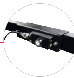
GAR 214TK 소나를 이용한 전기적 런아웃 측정
