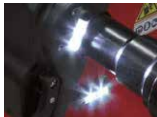
더블 LED 램프 휠 내측에 납을 교정 시 자동으로 LED 램프가 켜져서 납 부착 작업을 편리하게 해줍니다.
