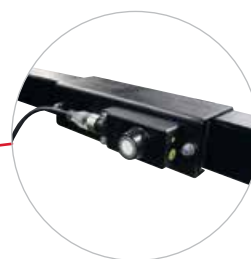
GAR 214TK 소나를 이용한 전기적 런아웃 측정
