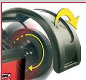
Автоматический запуск при опускании кожуха
