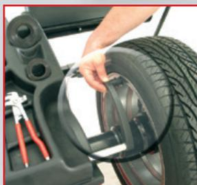
Измерительный рычаг для автоматического ввода ширины и диаметра
