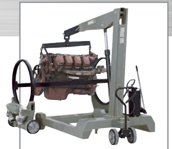
R15 • 2.000 kg • 2x0,5 kW • 1 rpm
