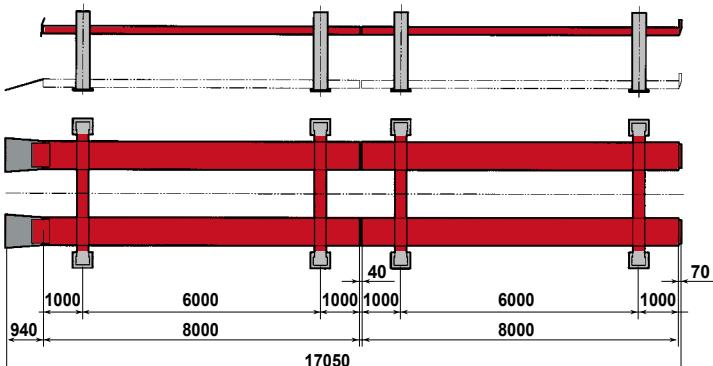
Pour les modèles LOGIC T240, T200, T140, T120 il est possible de jumeler 2 ponts afin de les faire fonctionner:
