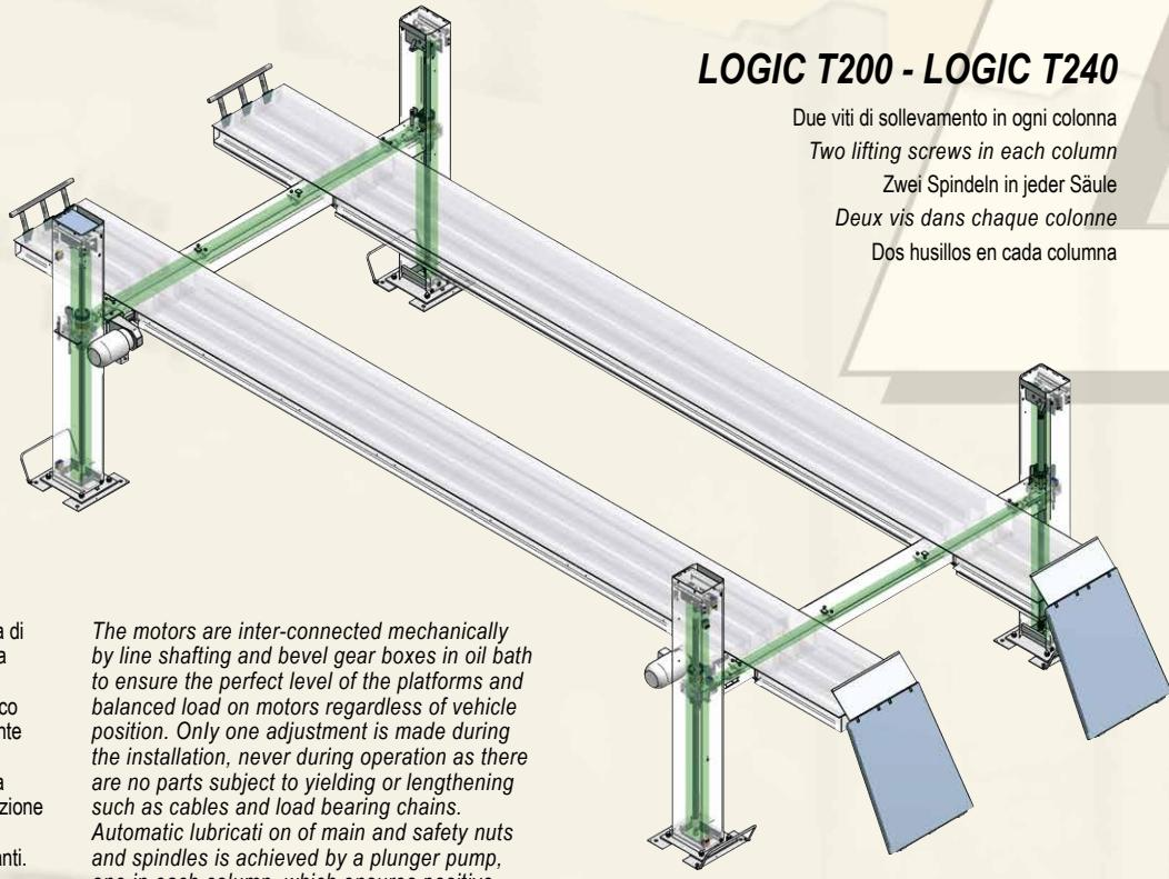
I motori sono collegati tra di loro mediante barra di trasmissione e scatole di rinvio con ingranaggi a bagno d'olio.
