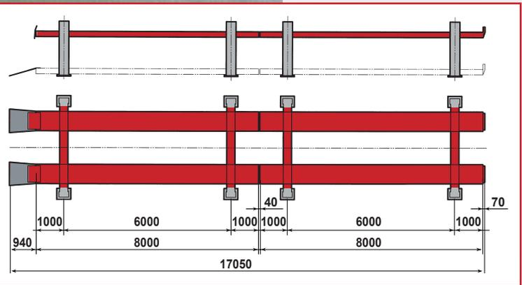
Pour les modèles LOGIC T240, T200, T140, T120 il est possible de jumeler 2 ponts afin de les faire fonctionner:
