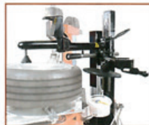
右側サポート「プラスデバイス」 ・タイヤ組込に役立つ「サポートバー」 ・下ビード外しに役立つ「サポートディスク」
