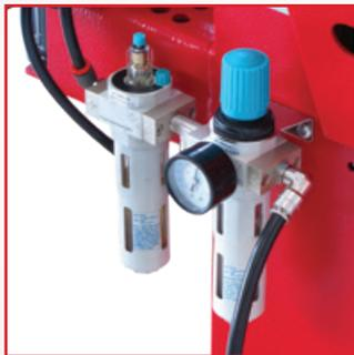
Filtro con regolatore di pressione e lubrificatore inclusi nella dotazione standard.
