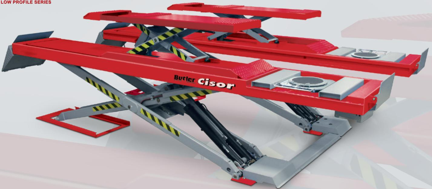
Ponte omologato CE, comandi in bassa tensione. Perna di articolazione con bocche autolubrificanti non richiedenti manutenzione. Assenza dei collegamenti meccanici tra le pedane (massima operatività nella zona di lavoro). Ad ogni singola discesa il ponte si livella perfettamente in modo automatico tramite una valvola di riallineo brevettata.
