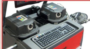
Rilevatori posteriori con orientamento automatico delle camere.
